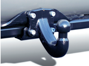
Abb. 11.2.1/1: a) Kupplung für Zentralachsanhänger bis zu 3,5 t zGM
