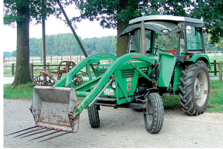
Abb. 5.2/1: Älterer Traktor mit einer mechanischen Bremsbetätigung auf die hintere Achse
