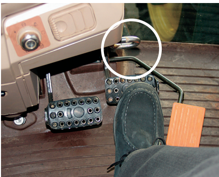
Abb. 5.2.1/1: Einzelradbremse gelöst (rechts)
